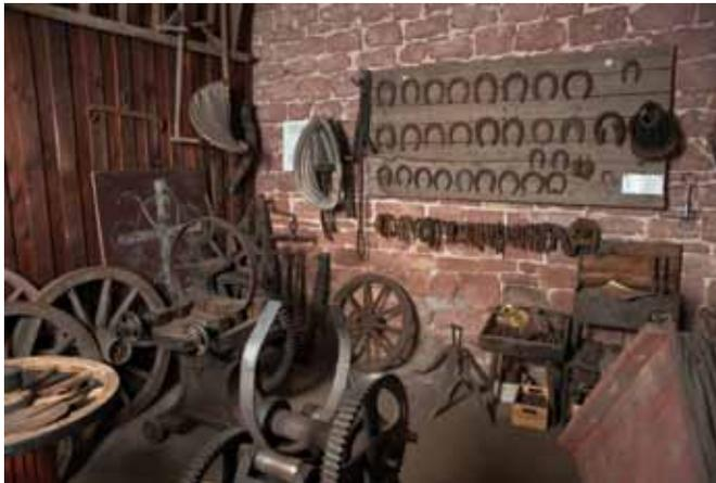
**Mit der Stauchmaschine werden** die gebogenen Reifen auf Maß zusammenschmiedet. Nicht immer entspricht das Ergebnis den erforderlichen Maßen. Auch ältere Reifen wurden durch die ständige Benutzung oft ausgedehnt und dadurch zu groß. In solchen Situationen wurde eine Stauchmaschine zum Zusammenschieben der zu groß gewordenen Reifen benutzt. Vor der Erfindung der Stauchmaschine wurden die Reifen auseinandergeschnitten und anschließend im Feuer wieder zusammenschmiedet.
